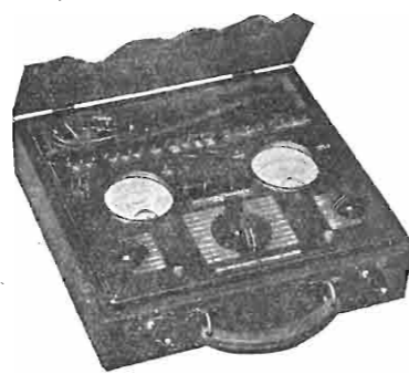
Analizzatore di Radioriceventi Mod. 444 a 2 strumenti indicatori. Peso kg. 5,3 - Dimensioni cm. 30x33x12
