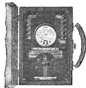
Volt-Ohmmetro Weston Mod. 663. Misura le tensioni da 0 a 1.000 Volt e le resistenze comprese fra 0,2 Ohm e 10.000.000 Ohm con la sola batteria interna. Peso kg. 2,7 - Dimensioni cm. 22x23x11.
